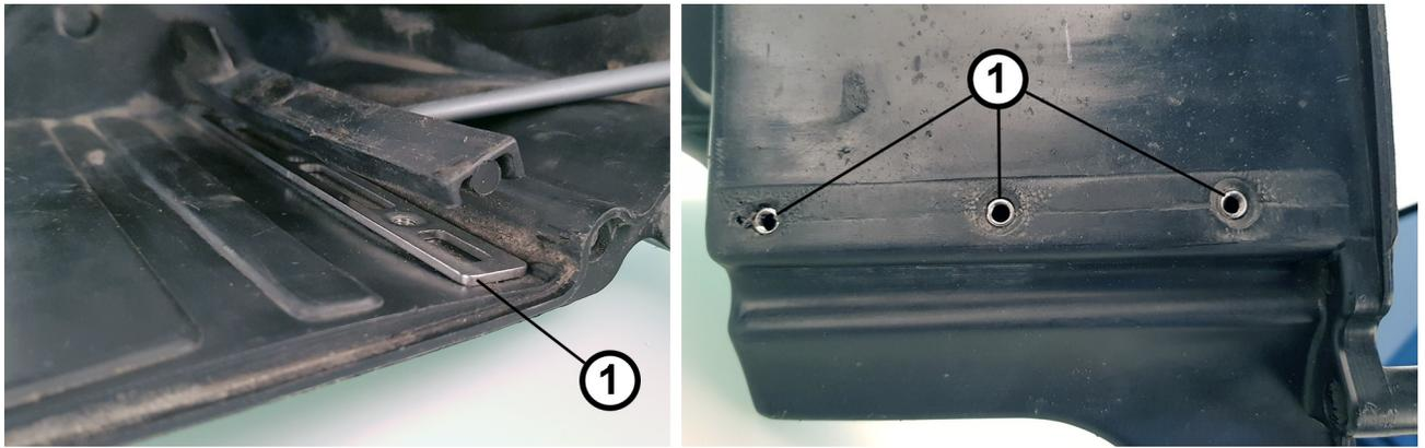
Die „Gewindeschiene“ (1) so in den Luftfilterkasten einsetzen, dass die durchgezogenen Gewinde in den Bohrungen sitzen.
