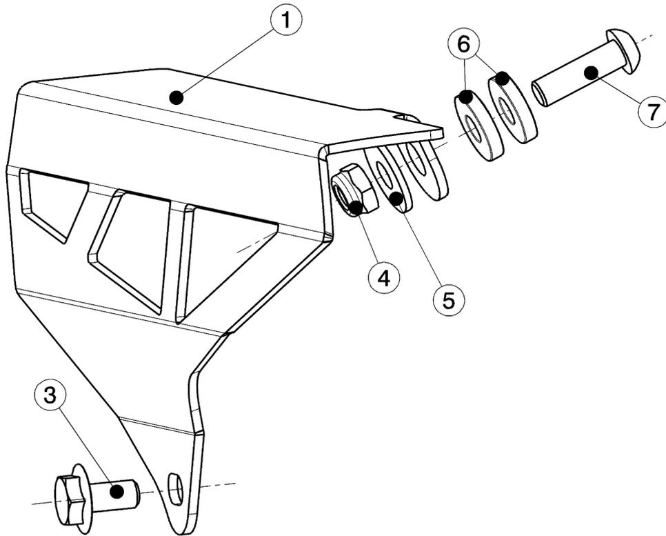
Montageanleitung, Kettenschutz einzeln, hinten:
