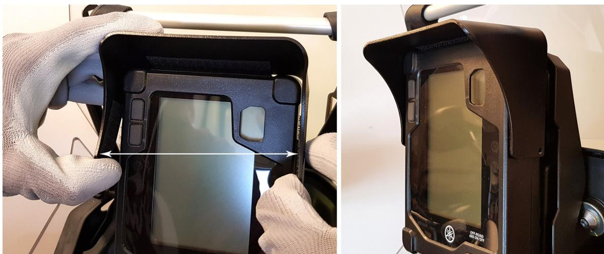
**(DE)** Beim Aufsetzen des Blendschutzes die Seitenteile leicht auseinander ziehen, oben auflegen und dann die Seiten ausrichten.
