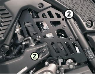
DE Das linke Seitenblech (2) mit den OEM-Schrauben (X), (Y) lose verschrauben.
