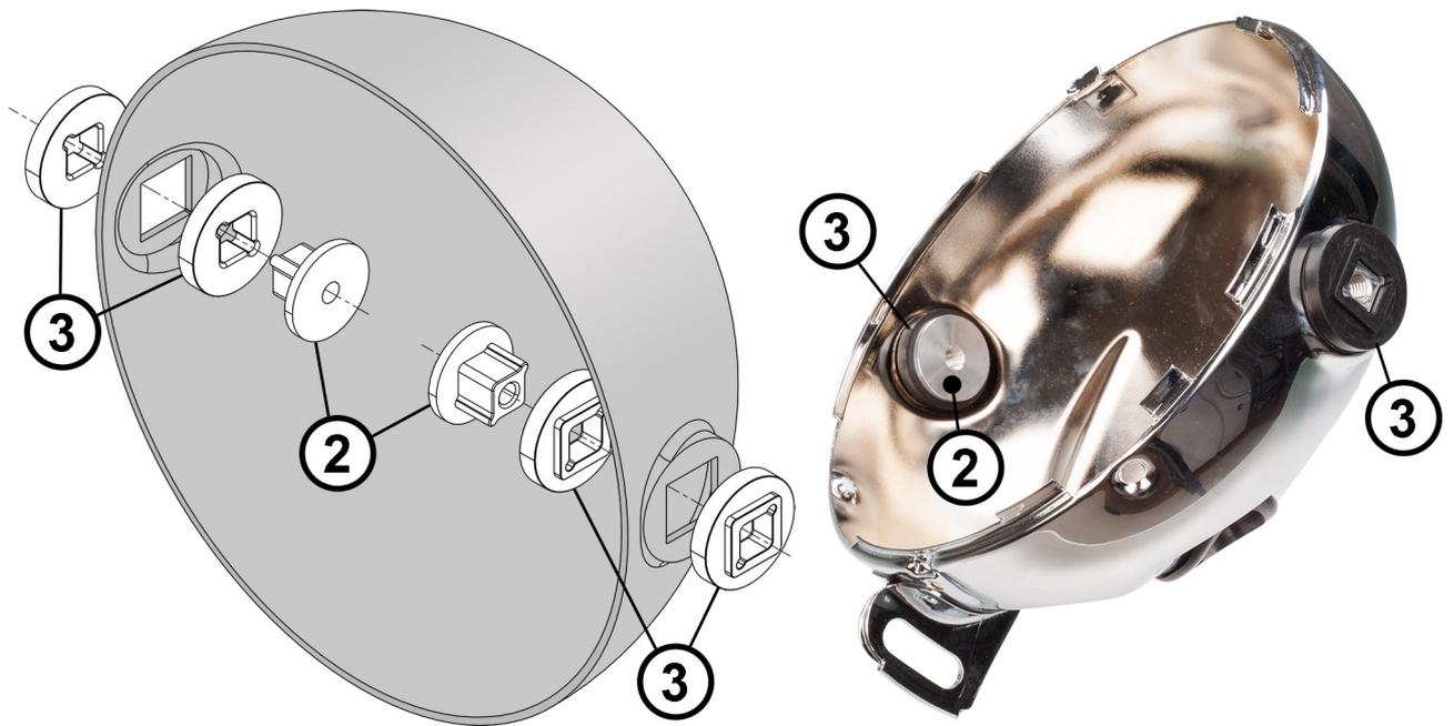
**DE** Die beiden Alu-Buchsen (2) – wie gezeigt - mit jeweils einem Gummi (3) bestücken und von innen in den Lampentopf einsetzen. Anschließend auf beiden Seiten einen weiteren Gummi (3) mit der flachen Seite zum Lampentopf anlegen.
