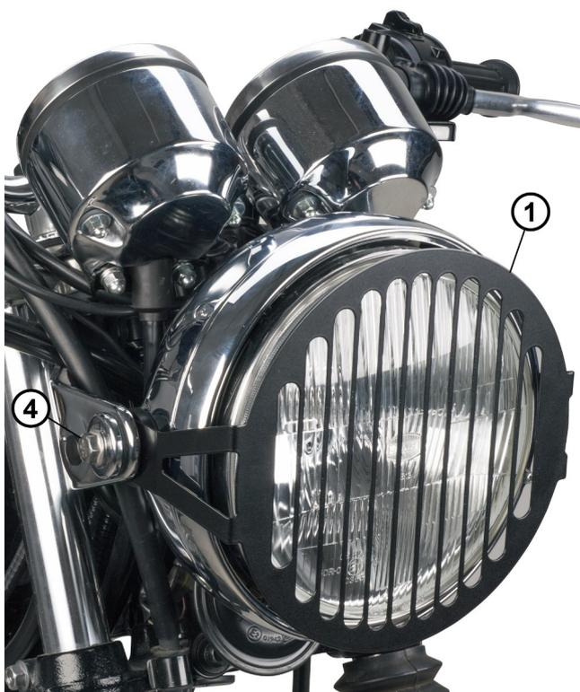
**DE** Abschließend den vorbereiteten Scheinwerfer inkl. Gitter mit den Schrauben (4) montieren und den Scheinwerfer ausrichten.
