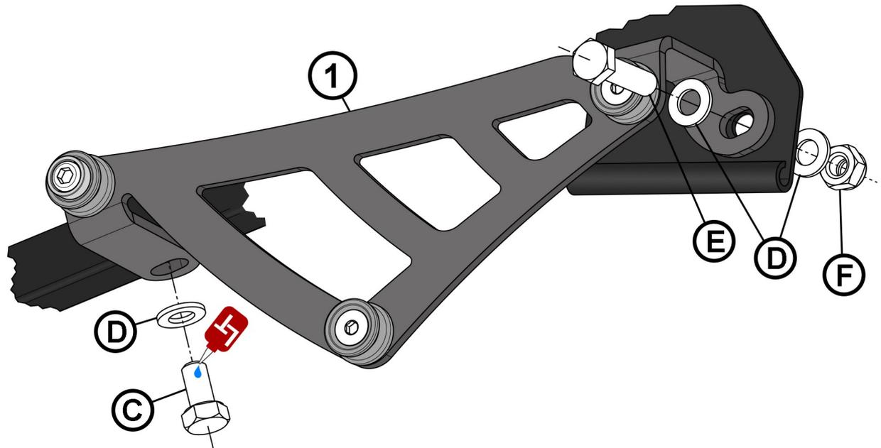
**DE** Für die Schraube (C) flüssige Schraubensicherung verwenden.
