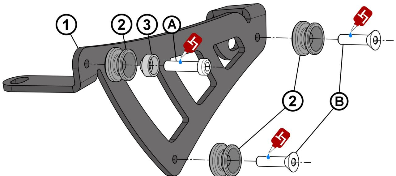
**DE** Für alle 3 Schrauben **(A)** und **(B)** flüssige Schraubensicherung verwenden und mit **7 Nm** anziehen.
