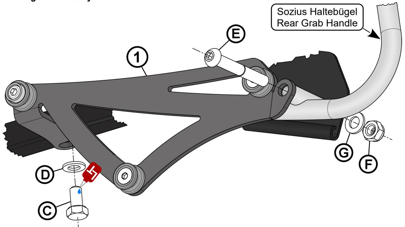
**DE** Für die Schraube (C) flüssige Schraubensicherung verwenden.
