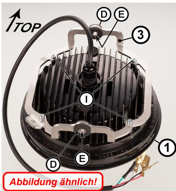
Den Adapterrahmen (2) wie gezeigt mit den Schrauben (I) auf dem LED-Einsatz (1) montieren.
