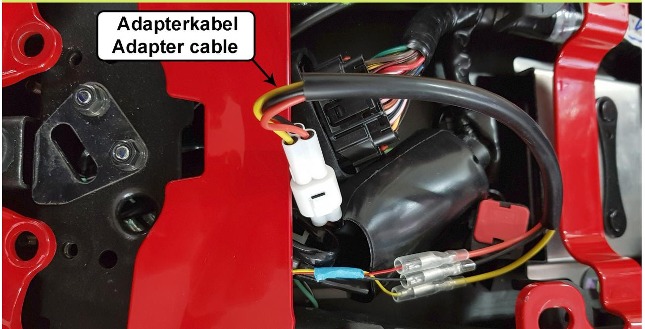
**DE** Das Rücklichtkabel mit Hilfe des Adapterkabels (3) anschließen.
