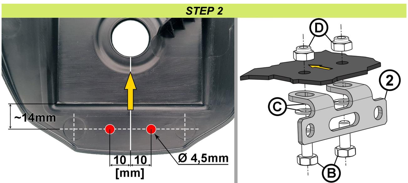
**DE** Zur Montage des Rücklicht-Halters müssen zwei Löcher in die untere Heckverkleidung gebohrt werden. Mittellinie, Bohrlinie und die beiden Bohrpunkte (●) anzeichnen. Für die Bohrungen empfehlen wir einen Holzbohrer mit einem Durchmesser von 4 – 4,5mm zu verwenden.
