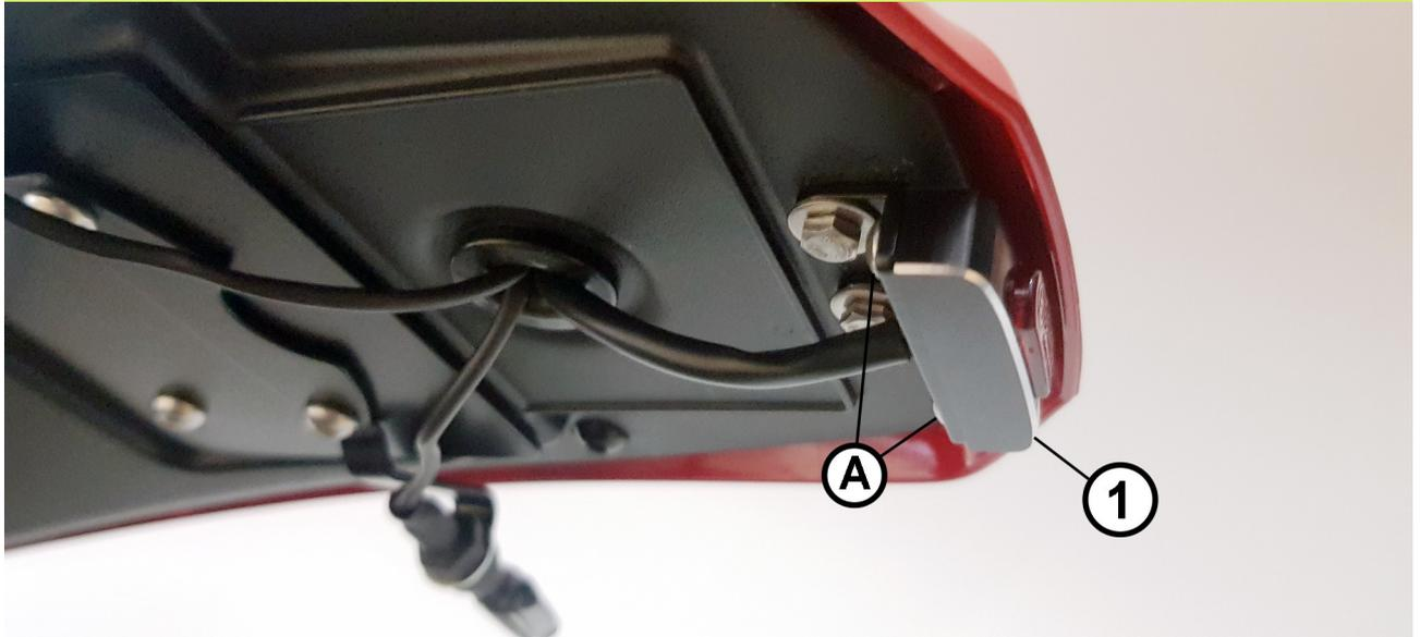
**DE** Das Rücklicht (1) mit den Schrauben (A) auf dem Halter (2) montieren.
