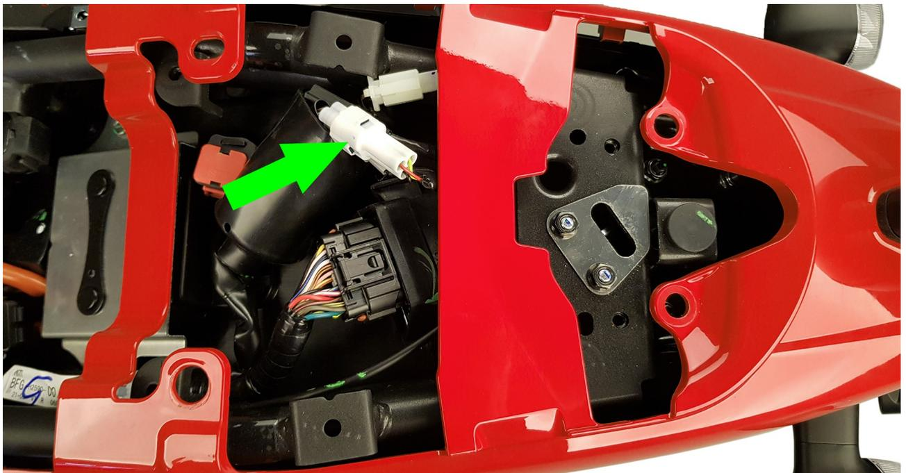
**DE** Die obere Heckverkleidung leicht nach hinten schieben, die markierte Steckverbindung (→) lösen und die obere Heckverkleidung abnehmen.
