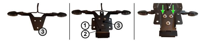
Blinker (z.B. LED-Blinker Blaze) auf dem Blinkerhalter montieren.
