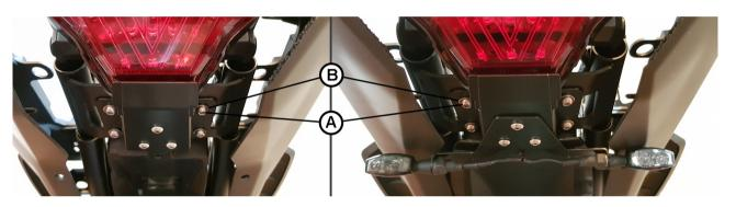
Den vorbereiteten Halter (1) mit den vier Schrauben (A) und den U-Scheiben (B) unter dem Rahmenheck befestigen.
