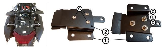
Die Sitzbank, den Soziussitz und Teile der Heckverkleidung demontieren, so dass die seitlichen Verkleidungsteile zur Seite gedreht werden können.
