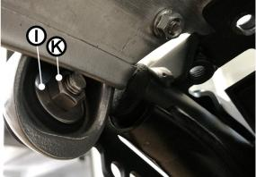
Den vorbereiteten Heckkotflügel (1), wie gezeigt, auf das Distanzblech (3) auflegen und mit den Schrauben (H), den U-Scheiben (I) und den Muttern (K) an den Haltern (4) und (5) montieren. Hierbei kann es notwendig sein, die U-Scheibe und die Mutter zwischen den Gusshalter und den Kotflügel zu führen und dann erst die Schraube durchzuführen, da die Scheibe und die Mutter sonst nicht an dem Kotflügel vorbei passen.
