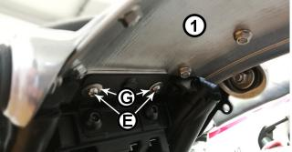
Anschließend die Sitzbank (Artikel-Nr.: JVB0039) in den vorderen Haken einsetzen und ggf. den unter der Sitzbank montierten hinteren Halter justieren, so dass die Sitzbank mit dem Rahmen und dem Fender verschraubt werden kann. Hierfür werden die Schrauben (E) und die U-Scheiben (G) verwendet.
