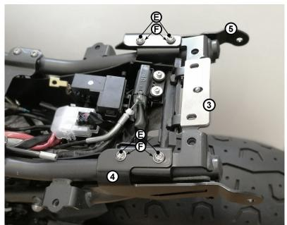
Die beiden beschichteten Edelstahlhalter (4) und (5) am Rahmenheck anbringen. Die Verschraubung erfolgt mit den Schrauben (E) und den kleinen U-Scheiben (F).
