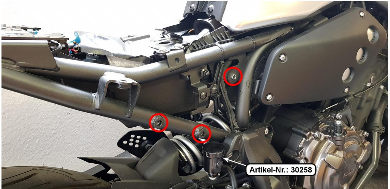
Der Bremsflüssigkeitsbehälter muss hierbei versetzt werden. KEDO bietet hierfür eine andere Halterung (**Artikel: 30296**) oder einen formschönen Alu-Behälter (**Artikel: 30258**) inkl. Halterung an.
