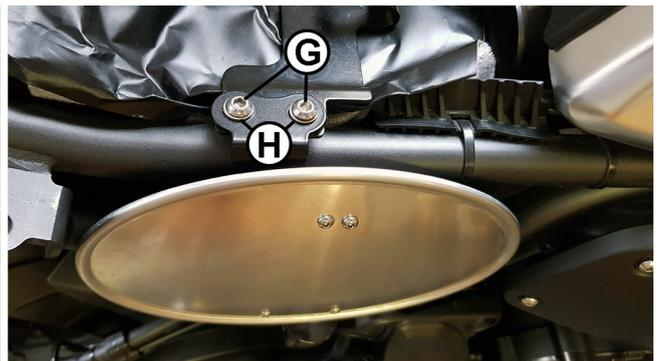
Die vorbereiteten Seitendeckel (1) mit dem unteren Halter in den Spalt hinter der Schraube (F) einsetzen und den oberen Halter mit den M6-Schrauben (G) und den U-Scheiben (H) an den Befestigungspunkten des vorderen Sitzbankhalters verschrauben.
