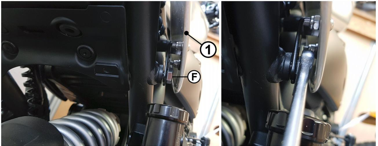
Anschließend wird die Schraube **(F)** fest angezogen.
