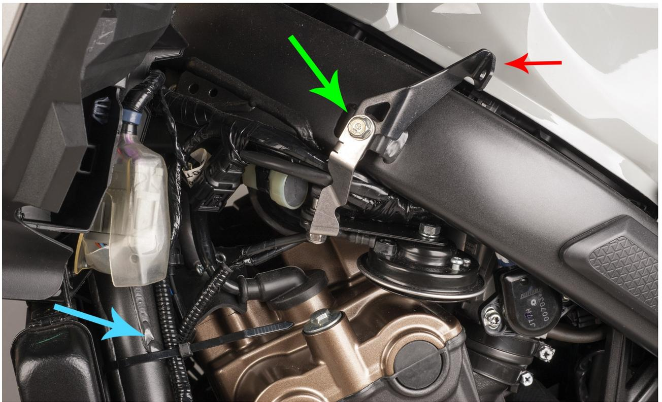
**DE** Der vormontierte Hupenhalter wird zusammen mit dem hinteren Halter verschraubt (→). Darauf achten, dass der hintere Halter (→) wieder in der richtigen Position sitzt. Wir empfehlen die Kabel der Hupe mit einem Kabelbinder am Rahmen zu fixieren (→).
