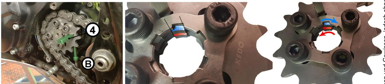
Um möglichst einfach an die Spannschraube zu gelangen, sollte das Hinterrad „frei“ sein, so dass Reparatur-Ritzel und Spannvorrichtung in die richtige Position gedreht werden können.
